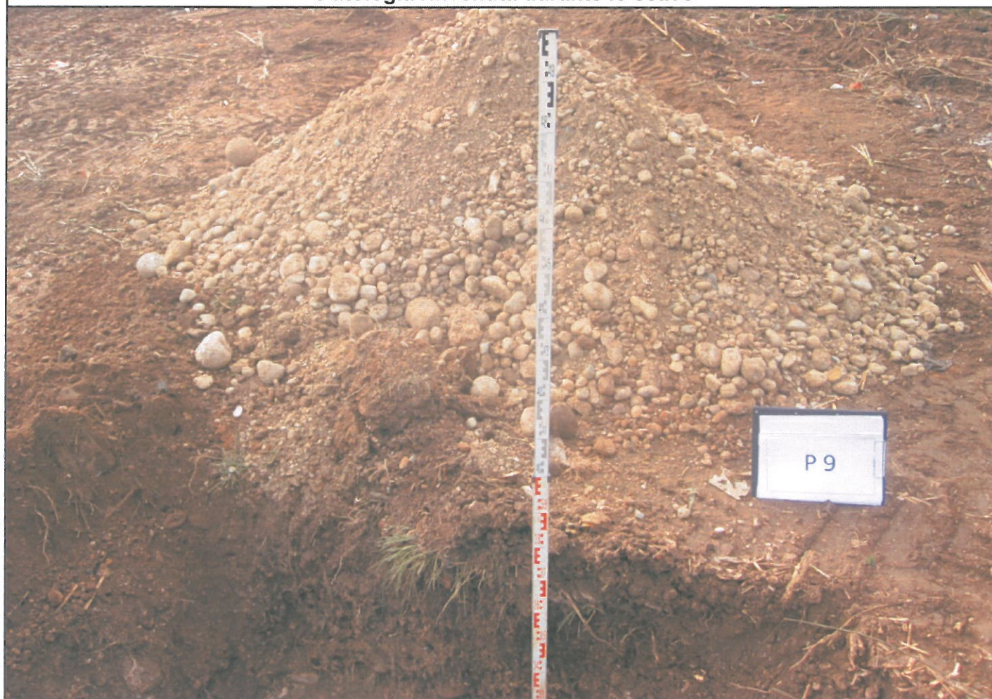
Vista d'insieme della sezione stratigrafica relativa alla trincea esplorativa n.9 e litologia rinvenuta durante lo scavo
